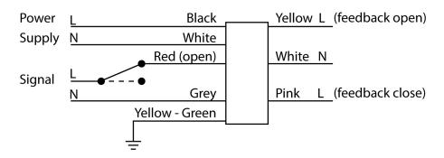
2ポイント指令:指令装置は簡易スイッチまたはポタンで制御(手動または自動。例:従来サーモスタット) 制御スイッチを切ると全CCWの位置にアクチュエーターが伝達される。アクチュエーターがボールバルプの上に取付けられた場合、制御スイッチを切るとポールバルプが開く。逆もまた同様。指令電圧と電動電圧が異なる場合も相談可。
